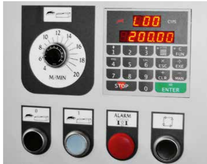
The thickener table electronic positioner, available on request, enables fast and precise worktable positionings. With calculator included. Die auf Anfrage lieferbare elektronische Dickentischpositionierung erlaubt schnelle und präzise Positionierungen. Rechnerfunktion eingeschlossen.
