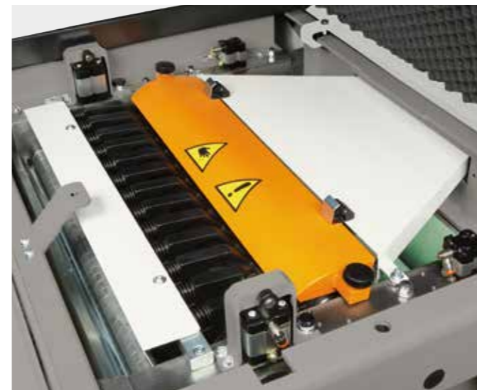
The PS 630 can be equipped, upon request, with pneumatic adjustment of the top feed rollers pressure from the front control panel rather than mechanical. The pneumatic pressure guarantees the same pressure with any stock removal. Die PS 630 kann auf Anfrage mit pneumatischer, anstatt mechanischer, vom Bedienpult einstellbarer Druckeinstellung auf den oberen Vorschubwalzen ausgerüstet sein. Der pneumatische Druck gewährleistet ständigen Druck mit jeglicher Spanabnahme.
