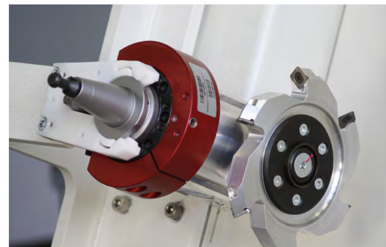
Automatic Spindle change / Cambio automático de mandril
